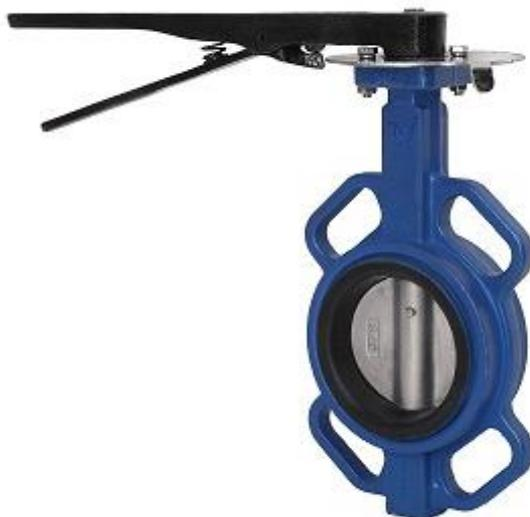
**Затворы дисковые** — вид трубопроводной арматуры, в котором запирающий или регулирующий элемент имеет форму диска, поворачивающегося вокруг оси, перпендикулярной или расположенной под углом к направлению потока рабочей среды.
