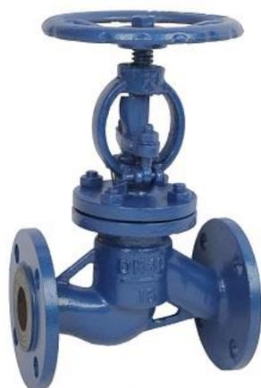
**Клапаны запорные** — вид трубопроводной арматуры, запирающий элемент которой, перемещается параллельно оси потока рабочей среды. Как и другие виды запорной арматуры, запорные клапаны применяются для полного перекрытия своего проходного сечения, а следовательно, потока рабочей среды; то есть запирающий элемент, которым в запорном клапане чаще всего является золотник, в процессе эксплуатации находится в крайних положениях «открыто» или «закрыто».
