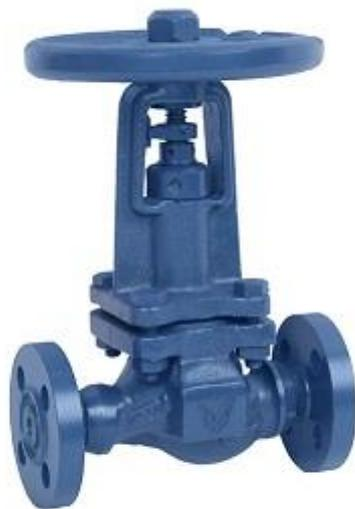
**Сильфонный клапан** является разновидностью запорного клапана, в котором при помощи сильфонного узла осуществлена герметизация подвижного соединения крышка-шпindel. Сильфонные клапаны применяются в случаях, когда в трубопроводных системах производится транспортирование взрывоопасных, токсичных, агрессивных и других сред, которые нуждаются в изоляции от внешней среды.
